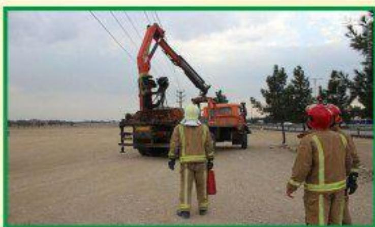
کارگری که روی زمین ایستاده و جرثقیل را لمس میکند و یا با بار برداشته شده و معلق در تماس است (چنانچه بار هادی جریان برق باشد) ممکن است دچار شوک جدی شود. این حالت درست مانند خطوط برق بدون عایق در شرایطی که در تماس با جرثقیل است ممکن است به خاطر اختلاف پتانسیل ایجاد شده توسط جریانات زمین، دچار برق گرفتگی شود. این که جرثقیل یا وسیله ای نقلیه تایرهای لاستیکی داشته باشند یا نه تفاوت زیادی نمی کند. زیرا ولتاژ بالا هم به وسیله جرقه از سطح جرثقیل و هم از طریق خود تایر به زمین تخلیه می شود.
