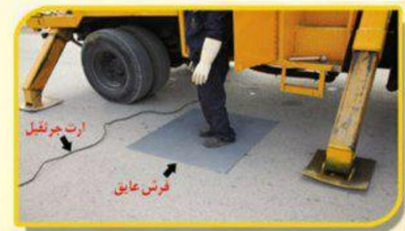
۵- چنانچه با کس کنترل جرثقیل در کنار قرار داشته باشد و اپراتور مجبور است در کنار جرثقیل روی زمین مستقر شود باستی از فرش عایق مناسب با ولتاژ شبکه به عنوان زیرپایی استفاده نماید.
